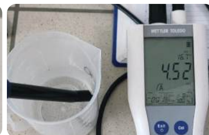
Вимірювання рН води за допомогою рН метра
